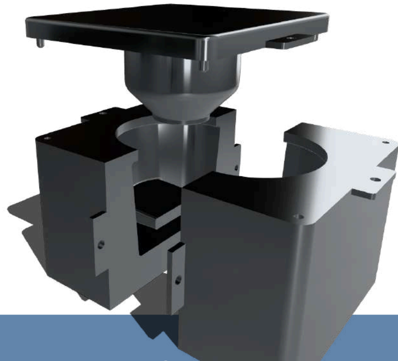
Molde Módulo Hormigón
